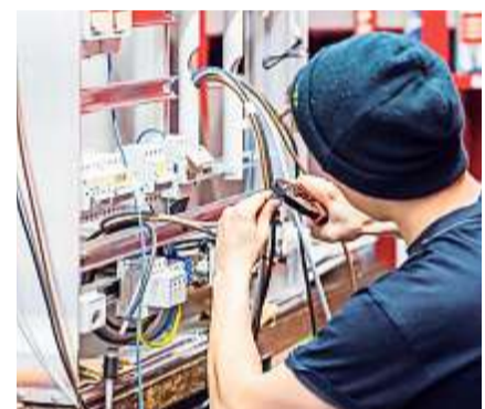
Verdrahtung einer Elektroverteilung nach Schema in der Werkstatt.
