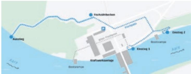
Beim neuen Fischpass in Bannwil handelt es sich um ein komplexes Bauwerk – er bietet zwei getrennte Einstiege im Unterwasserbereich: einen nahe der Turbinenausläufe für schwimmstarke Arten wie Lachs und Forelle sowie einen
